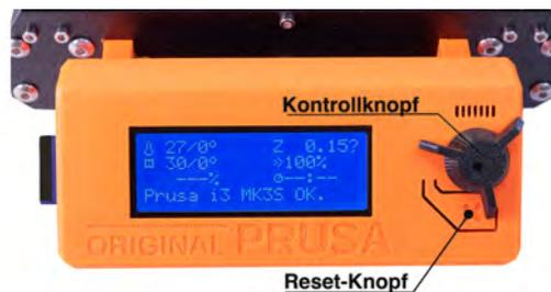
Bild 15 - LCD-Anzeige und Kontrollknöpfe
