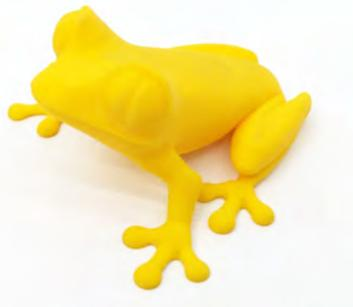
*Bild 25 - der 50-Mikrometer-Baumfrosch wird häufig als 3D-Druck-Benchmark verwendet.*
