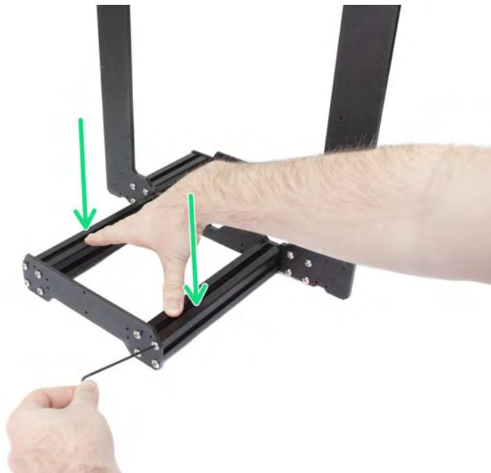
*Bild 45 - Die richtige Verbindung von Rahmen, Platten und Aluminiumprofilen.*
