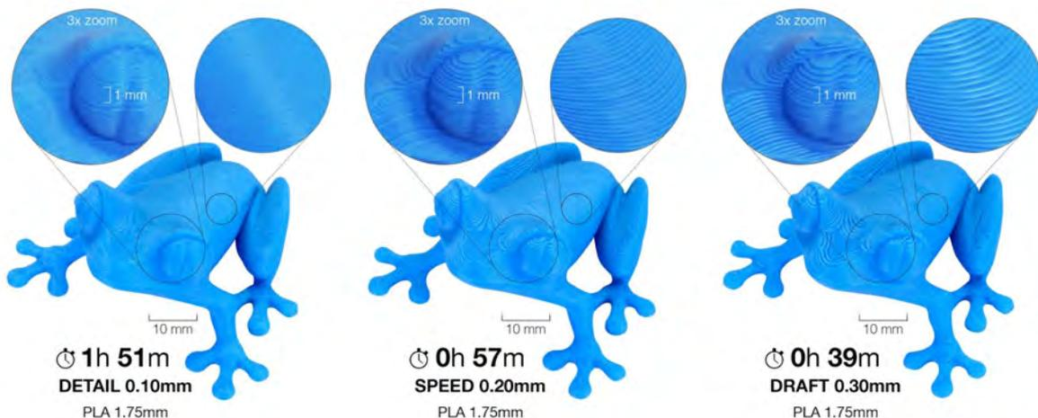
Bild 19 - Druckqualität vs. Druckzeit
